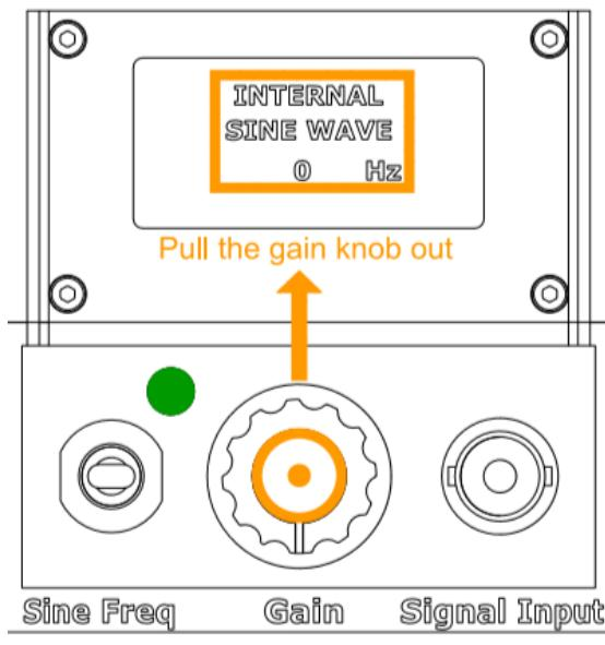
将正弦频率发生器开关升高或降低到所需的正弦频率。通过顺时针转动增益旋钮来调整放大器的增益。生成的正弦信号的频率将显示在 LCD 屏幕上。
