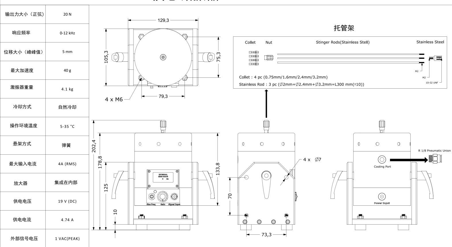
系统组成 : 电动振动器 + 电源适配器 + 5米信号电缆(BNC连接器- BNC连接器)+ R 1/8 气动接头 + 托管架 + 用户手册
