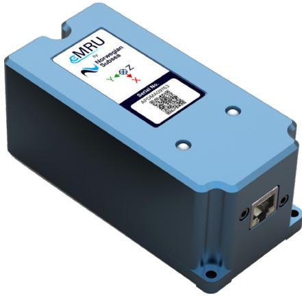
NORSUB MRU是高性能、紧凑且价格合理的6自由度运动传感器。它们使用最先进的MEMS技术和先进的传感器融合算法,实现精确可靠的滚转、俯仰、偏航、喘振、摇摆、升沉位置和速度测量。在水平加速度和不规则耦合运动中,性能也很高。
